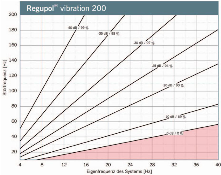
Dargestellt ist die Isolierung für einen Ein-Massen-Schwinger auf starrem Untergrund mit Regupol® vibration 200. Parameter: Kraftübertragungsmaß in dB, Isolierwirkungsgrad in %.
