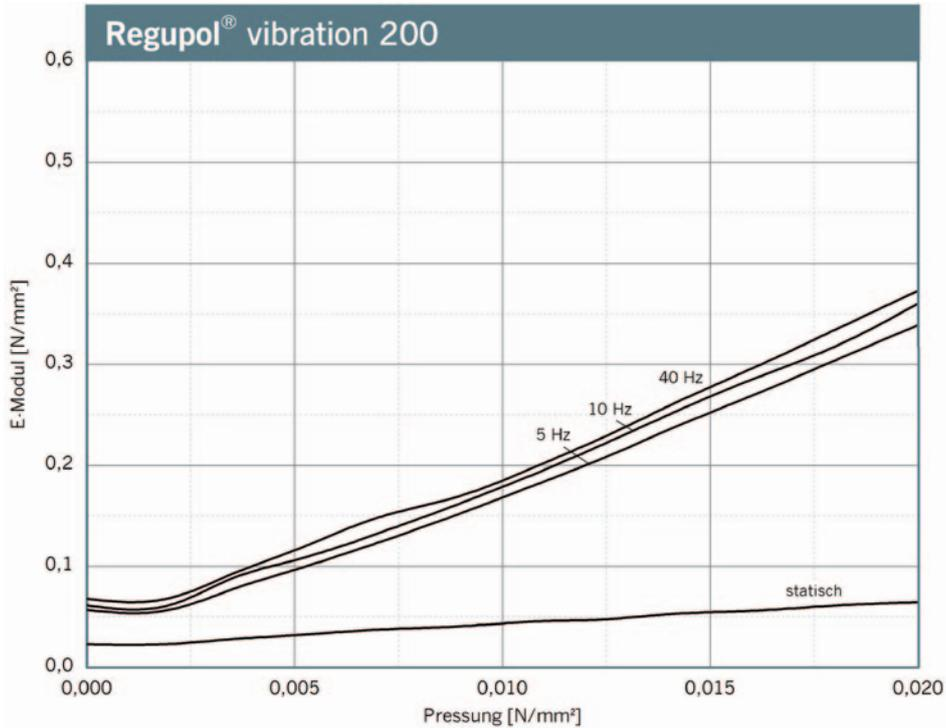
Verlauf des dynamischen E-Moduls bei sinusförmiger Anregung um eine konstante Mittelast, Wegamplitude  $\pm 0,25$  mm. Probenabmessung 300 mm x 300 mm x 34 mm; Statischer E-Modul als Tangentenmodul aus der Federkennlinie. Messung in Anlehnung an DIN 53513.
