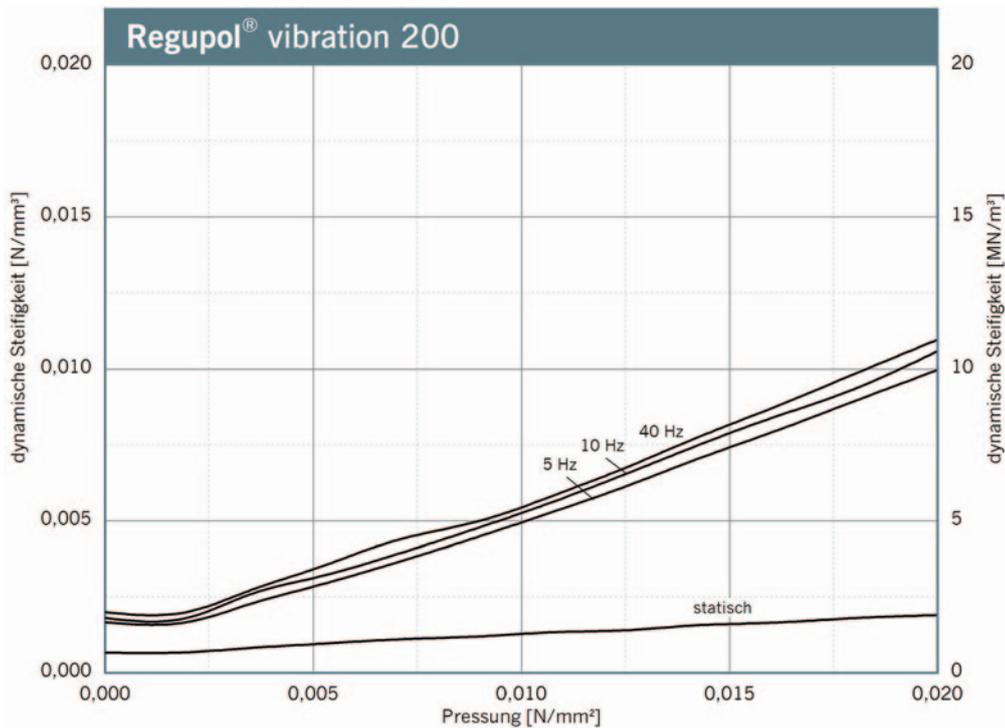
Verlauf der dynamischen Steifigkeit bei sinusförmiger Anregung um eine konstante Mittelast, Wegamplitude  $\pm 0,25$  mm. Probenabmessung 300 mm x 300 mm x 34 mm; Statische Steifigkeit als Tangentenmodul aus der Federkennlinie. Messung in Anlehnung an DIN 53513.
