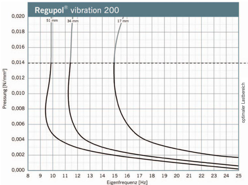
Eigenfrequenzverläufe für einen eindimensionalen Feder-Masse-Schwinger unter Berücksichtigung der dynamischen Steifigkeit von Regupol® vibration 200 auf starrem Untergrund. Probenabmessung 300 mm x 300 mm.
