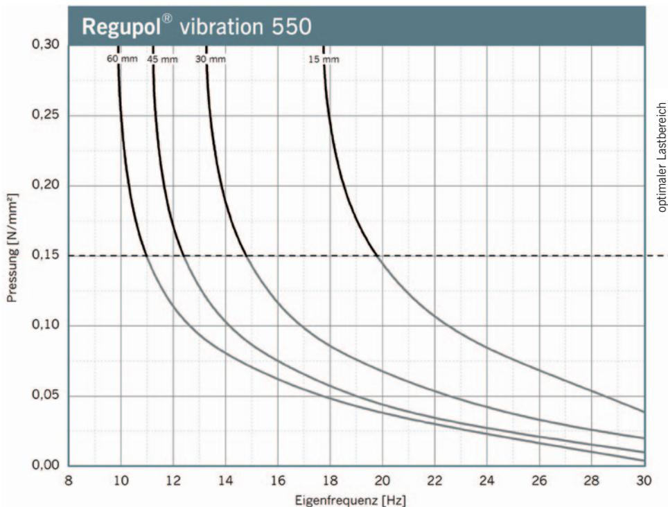
Eigenfrequenzverläufe für einen eindimensionalen Feder-Masse-Schwinger unter Berücksichtigung der dynamischen Steifigkeit von **Regupol®** vibration 550 auf starrem Untergrund. Probenabmessung 300 mm x 300 mm.
