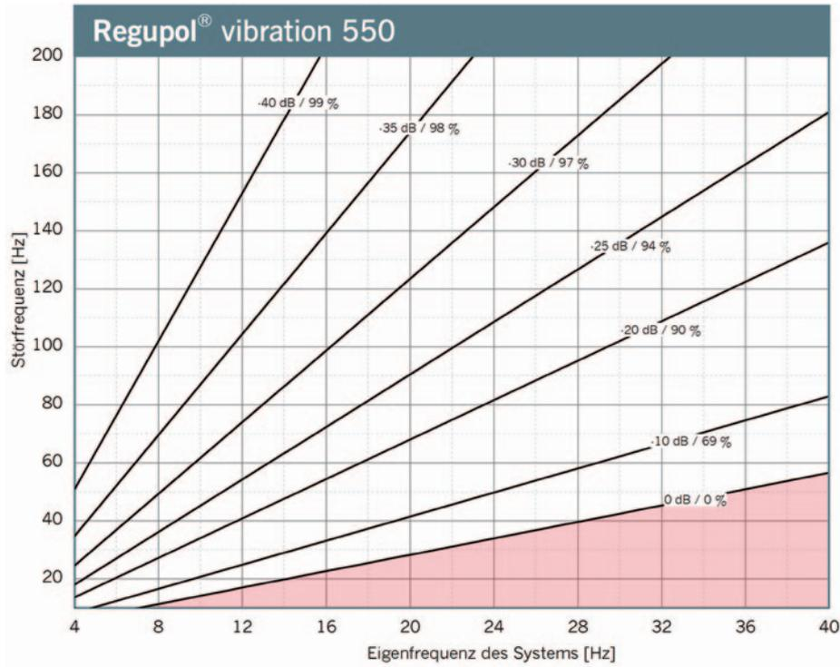
Dargestellt ist die Isolierung für einen Ein-Massen-Schwinger auf starrem Untergrund mit **Regupol®** vibration 550. Parameter: Kraftübertragsmaß in dB, Isolierwirkungsgrad in %.
