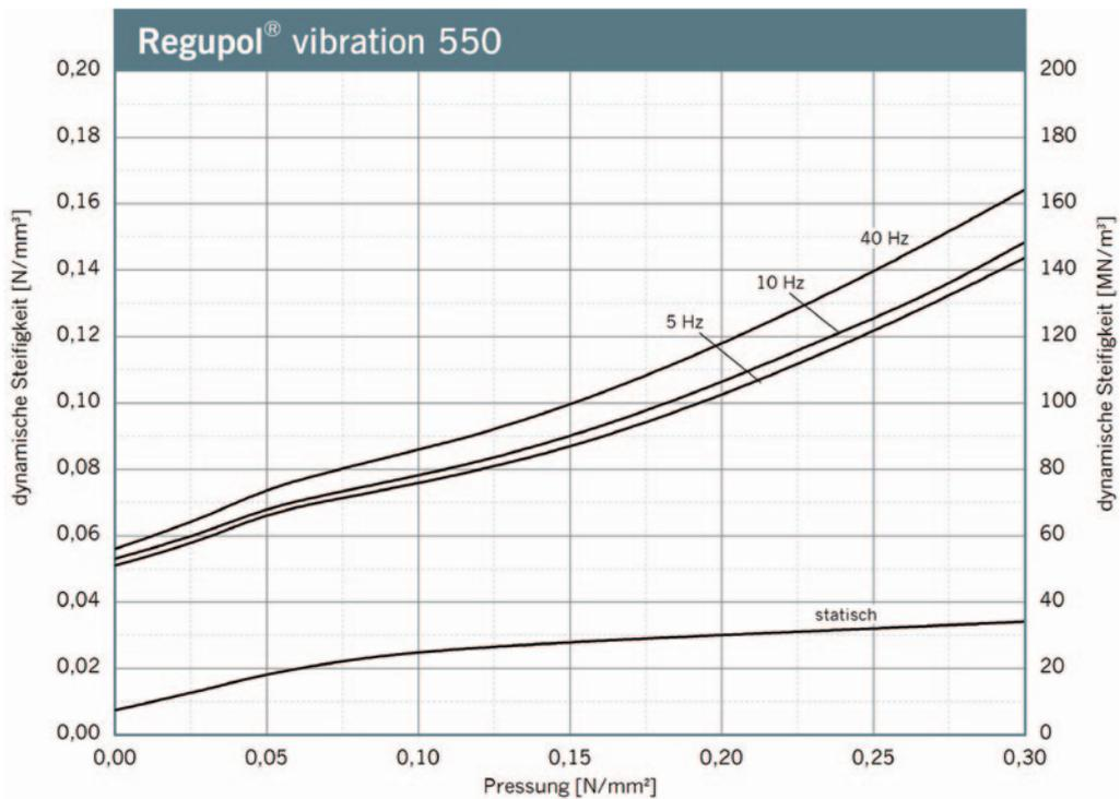
Verlauf der dynamischen Steifigkeit bei sinusförmiger Anregung um eine konstante Mittellast, Wegamplitude  $\pm 0,25$  mm. Probenabmessung 300 mm x 300 mm x 45 mm; Statische Steifigkeit als Tangentenmodul aus der Federkennlinie. Messung in Anlehnung an DIN 53513.
