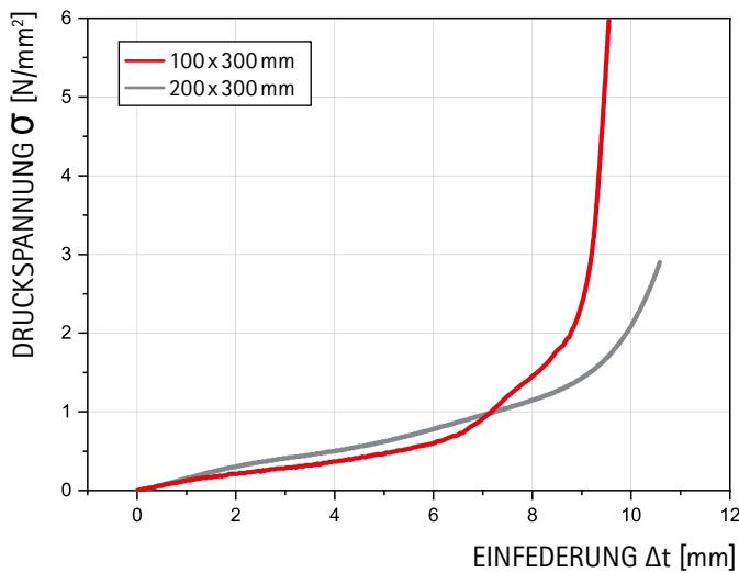
Druckstauchungs-Kurve bis zum Bemessungswert der Tragfähigkeit
