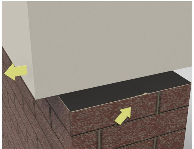
Auch schon geringe Unebenheiten der Oberflächen verhindern beim Einsatz einer Gleitfolie die horizontale Verschiebung.
