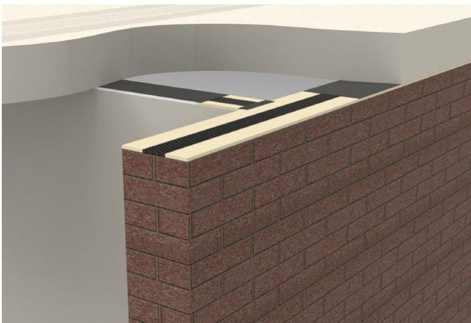
Die Auflagerflächen müssen plan, sauber, trocken und fettfrei sein. Grate sind zu entfernen und Löcher zu schließen. Bei windigem Wetter sind Cigular®-Deckenlager gegen Abheben zu sichern.
