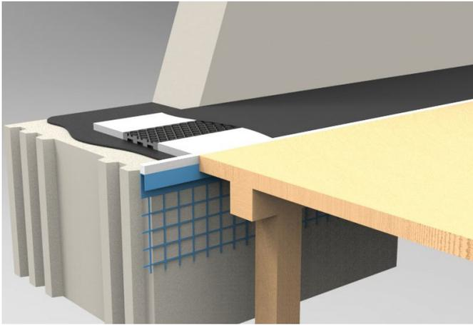
Cigular®-Deckenlager werden mit nach oben weisender Kunststoffabdeckung, stumpf gestoßen, auf die Auflagerflächen der Tragkonstruktion gelegt. Der einseitig selbstklebende Überlappungsstreifen muss auf das zuvor verlegte Lager vollflächig aufgedrückt werden, so dass später beim Betonieren der Decke die Stoßfuge geschlossen und damit funktionsfähig bleibt.
