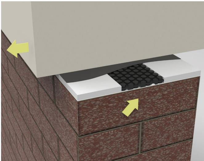
Aufnahme von Unebenheiten auf den Oberflächen werden elastisch ausgeglichen und schränken die Verformungsmöglichkeiten nicht ein.
