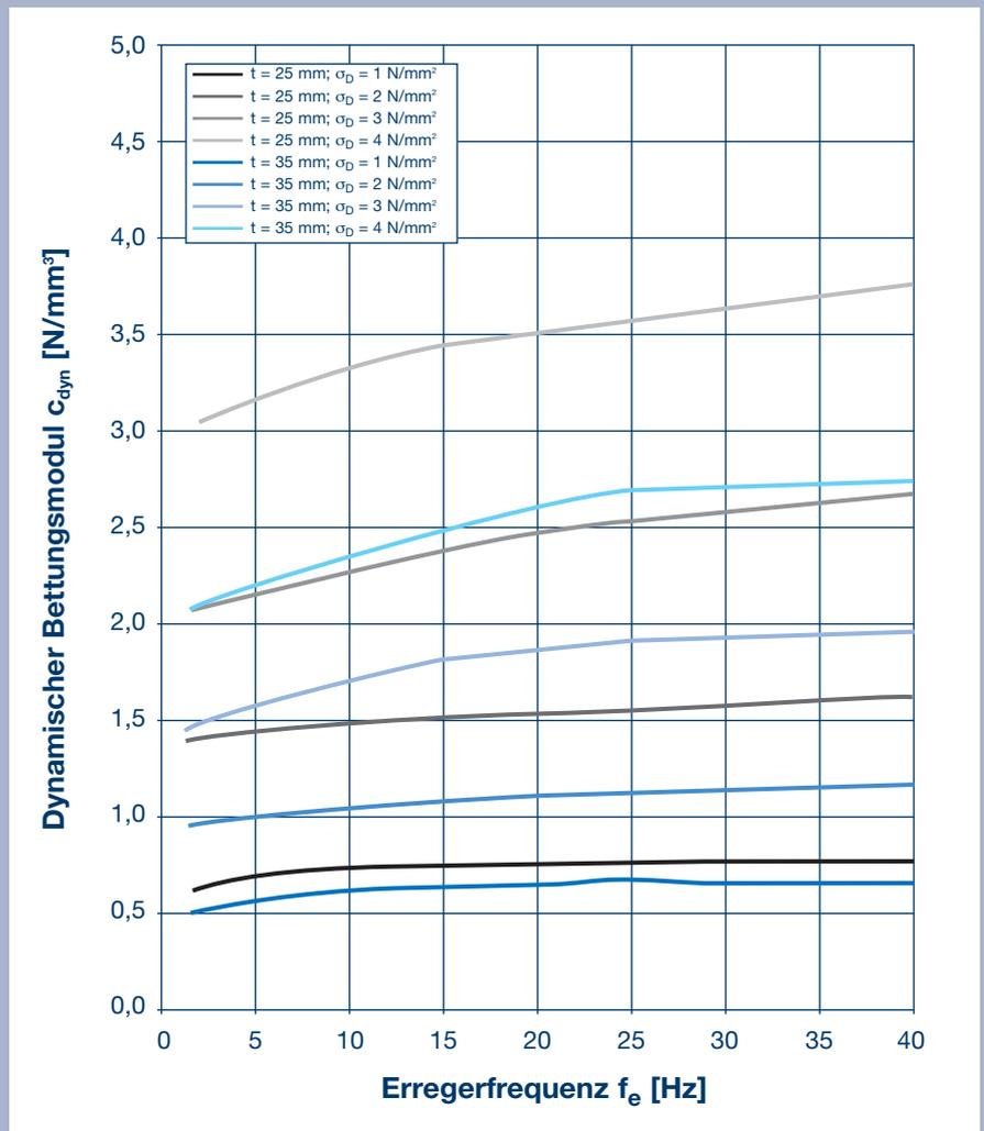
Bei einer Schwinggeschwindigkeitsamplitude von 1 mm/s
