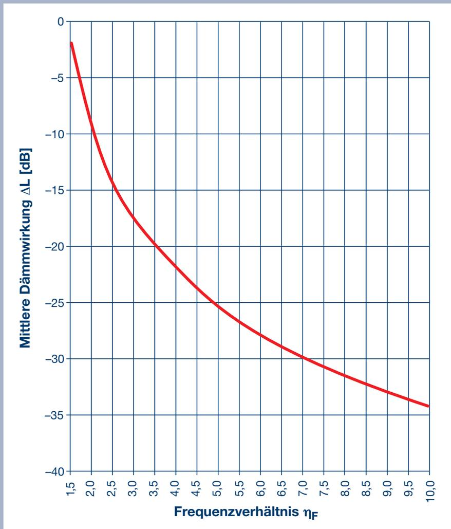
Bei einer Schwinggeschwindigkeitsamplitude von 1 mm/s
