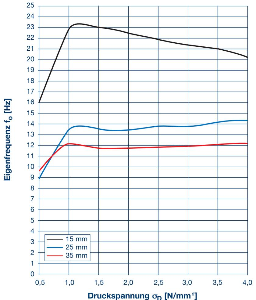
Bei einer Schwinggeschwindigkeitsamplitude von 1 mm/s
