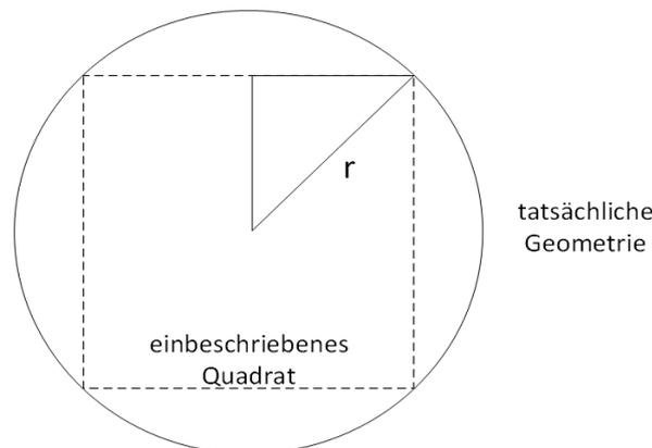
Abbildung 1: Ansetzbare Fläche bei runden Lagern zur Ermittlung des Formfaktors  $S_{\text{mod}}$ .
