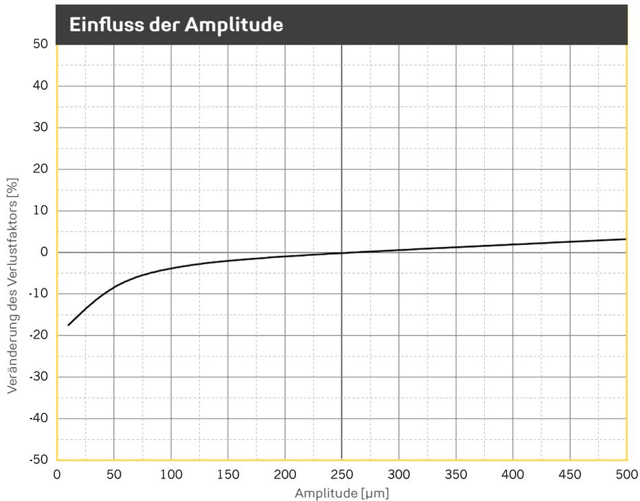
Veränderung des Verlustfaktors aufgrund geänderter Amplitude. Sinusförmige Anregung bei konstanter Mittellast von 0,018 N/mm<sup>2</sup>, Probenabmessung 300 x 300 x 25 mm.
