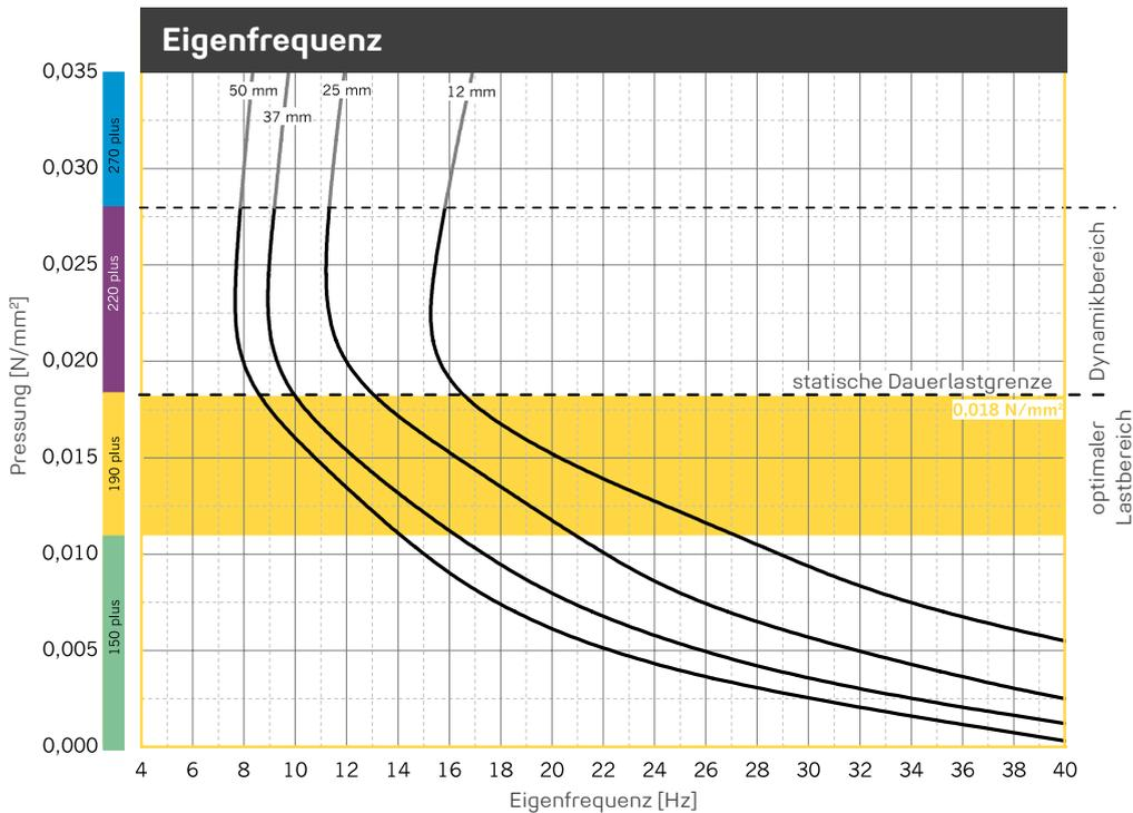
Eigenfrequenzverläufe für einen eindimensionalen Feder-Masse-Schwinger unter Berücksichtigung der dynamischen Steifigkeit von **REGUFOAM vibration 190plus** auf starrem Untergrund. Probenabmessung 300 mm x 300 mm.
