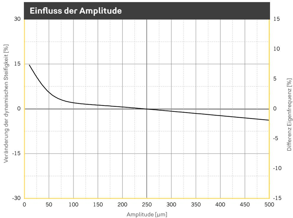
Veränderung der Steifigkeit aufgrund geänderter Amplitude. Mittelwert für 5 Hz, 10 Hz und 40 Hz Anregung bei konstanter Mittellast von 0,018 N/mm<sup>2</sup>, Probenabmessung 300 x 300 x 25 mm. Eigenfrequenz für einen eindimensionalen Feder-Masse-Schwinger auf starrem Untergrund.
