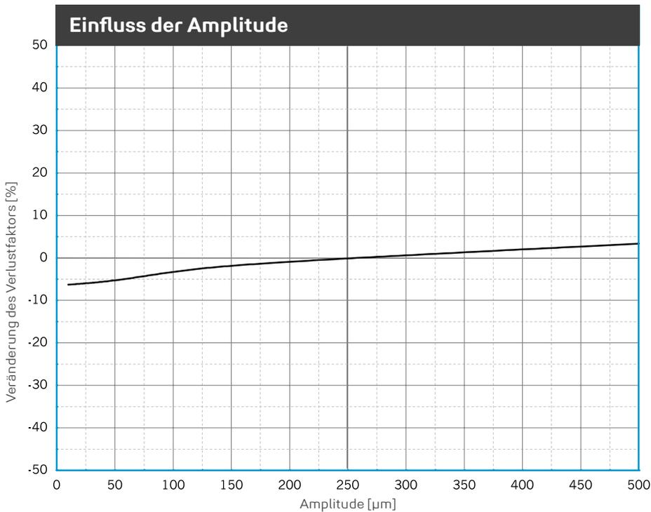
Veränderung des Verlustfaktors aufgrund geänderter Anregeamplitude. Sinusförmige Anregung bei konstanter Mittellast von 0,042 N/mm<sup>2</sup>, Probenabmessung 300 x 300 x 25 mm.
