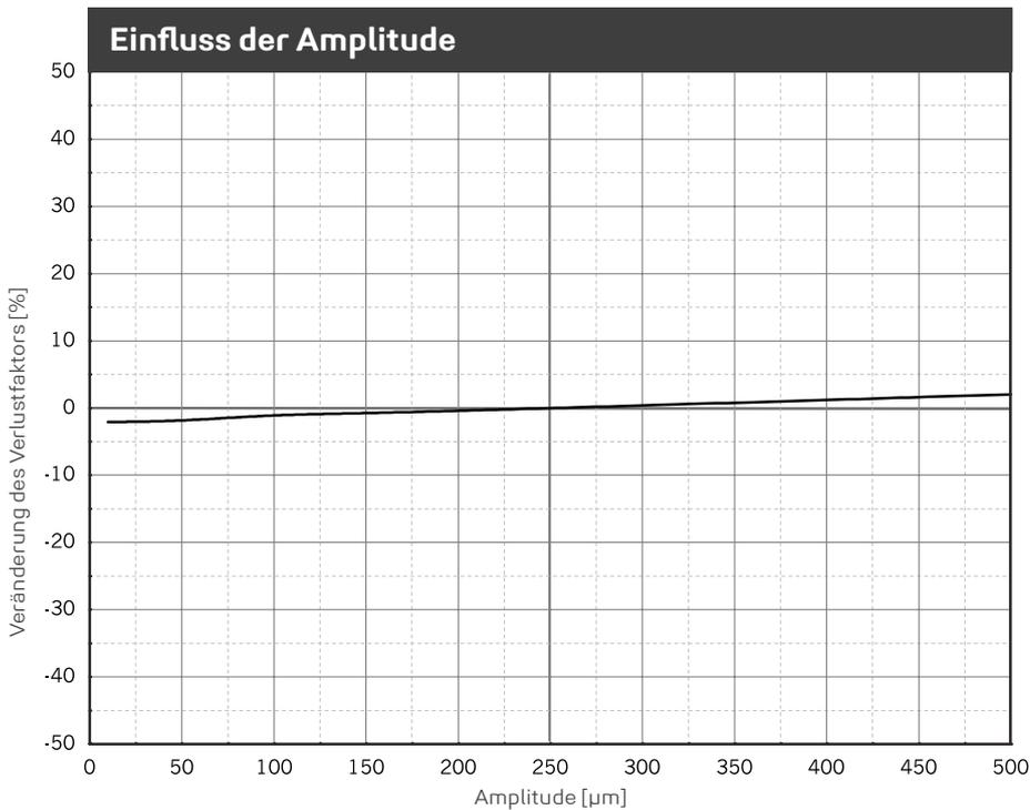
Veränderung des Verlustfaktors aufgrund geänderter Amplitude. Sinusförmige Anregung bei konstanter Mittellast von 0,055 N/mm<sup>2</sup>; Probenabmessung 300 x 300 x 25 mm.
