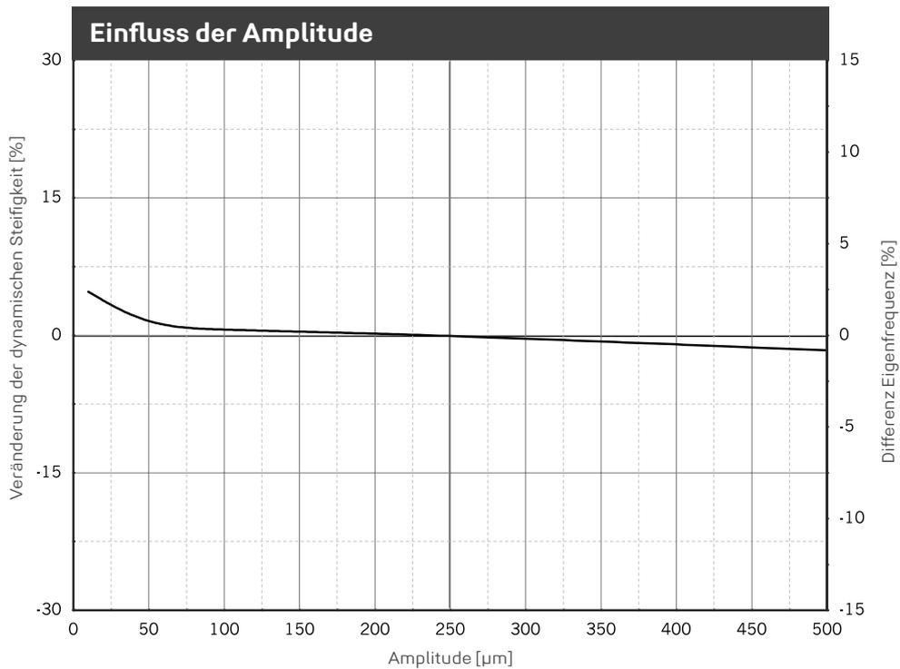
Veränderung der Steifigkeit aufgrund geänderter Amplitude. Mittelwert für 5 Hz, 10 Hz und 40 Hz Anregung. Sinusförmige Anregung bei konstanter Mittellast von 0,055 N/mm<sup>2</sup>; Probenabmessung 300 x 300 x 25 mm. Eigenfrequenz für einen eindimensionalen Feder-Masse-Schwinger auf starrem Untergrund.
