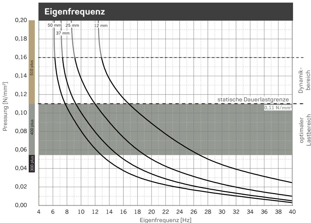
Eigenfrequenzverläufe für einen eindimensionalen Feder-Masse-Schwinger unter Berücksichtigung der dynamischen Steifigkeit von **REGUFOAM vibration 400plus** auf starrem Untergrund. Probenabmessung 300 mm x 300 mm.
