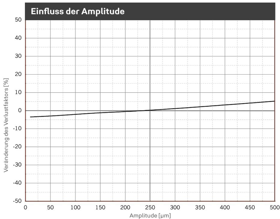
Veränderung des Verlustfaktors aufgrund geänderter Anregeamplitude. Sinusförmige Anregung bei konstanter Mittellast von 0,850 N/mm<sup>2</sup>; Probenabmessung 250 x 250 x 25 mm.
