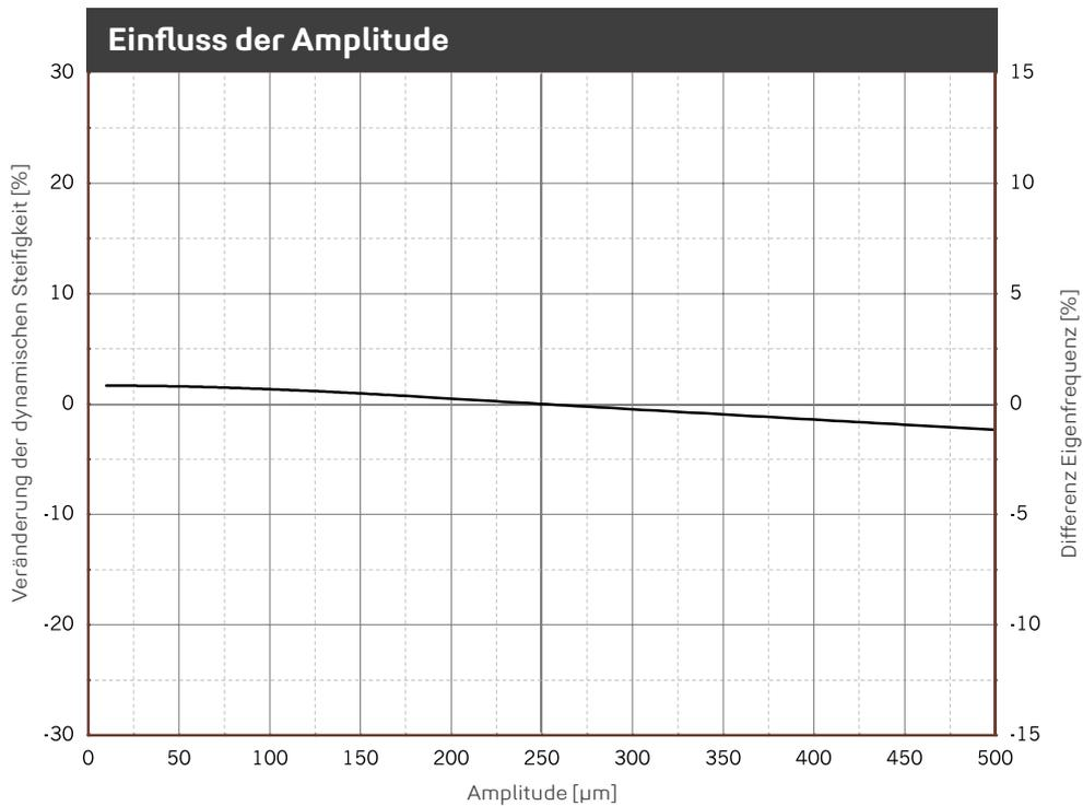
Veränderung der Steifigkeit aufgrund geänderter Anregeamplitude. Mittelwert für 5 Hz, 10 Hz und 40 Hz Anregung. Sinusförmige Anregung bei konstanter Mittellast von 0,850 N/mm<sup>2</sup>; Probenabmessung 250 x 250 x 25 mm. Eigenfrequenz für einen eindimensionalen Feder-Masse-Schwinger auf starrem Untergrund.
