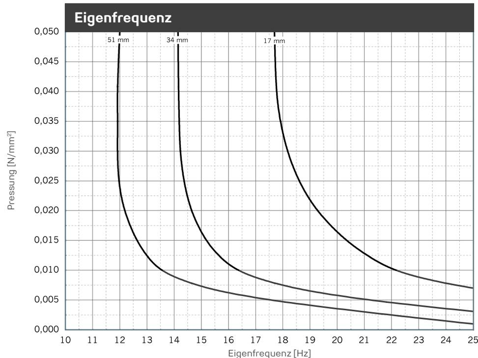
Eigenfrequenzverläufe für einen eindimensionalen Feder-Masse-Schwinger unter Berücksichtigung der dynamischen Steifigkeit von **REGUPOL vibration 300** auf starrem Untergrund. Probenabmessung 300 mm x 300 mm.
