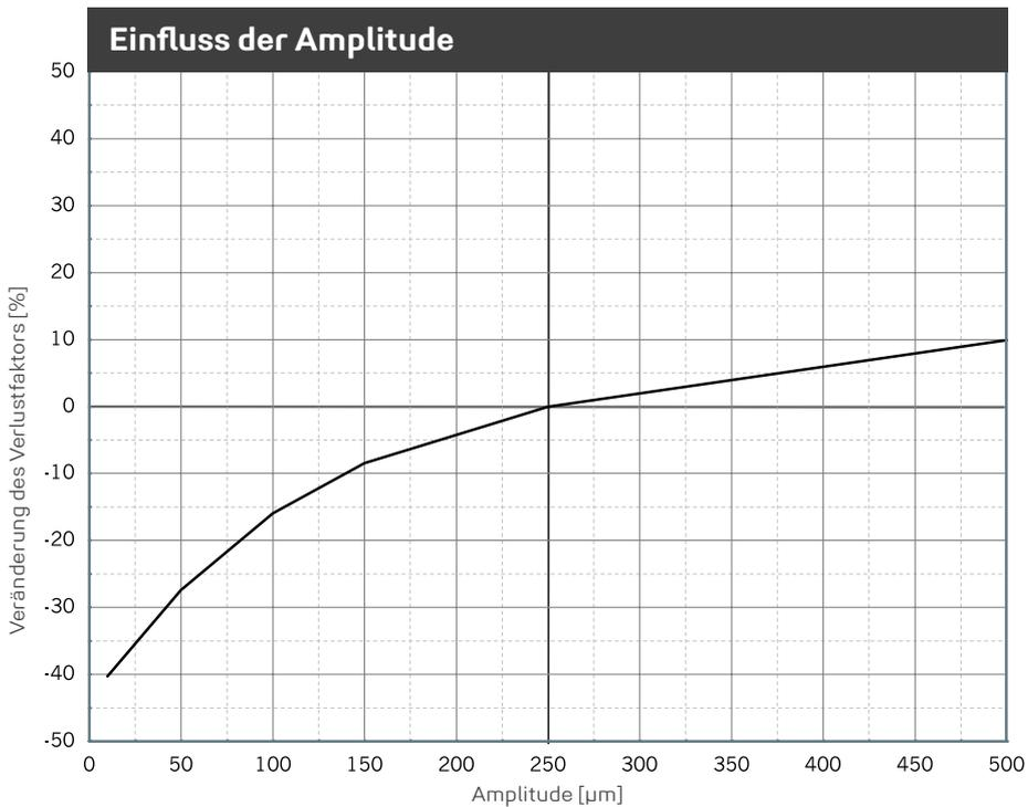
Veränderung des Verlustfaktors aufgrund geänderter Amplitude. Sinusförmige Anregung bei konstanter Mittellast von 0,05 N/mm<sup>2</sup>, Probenabmessung 300 x 300 x 51 mm.
