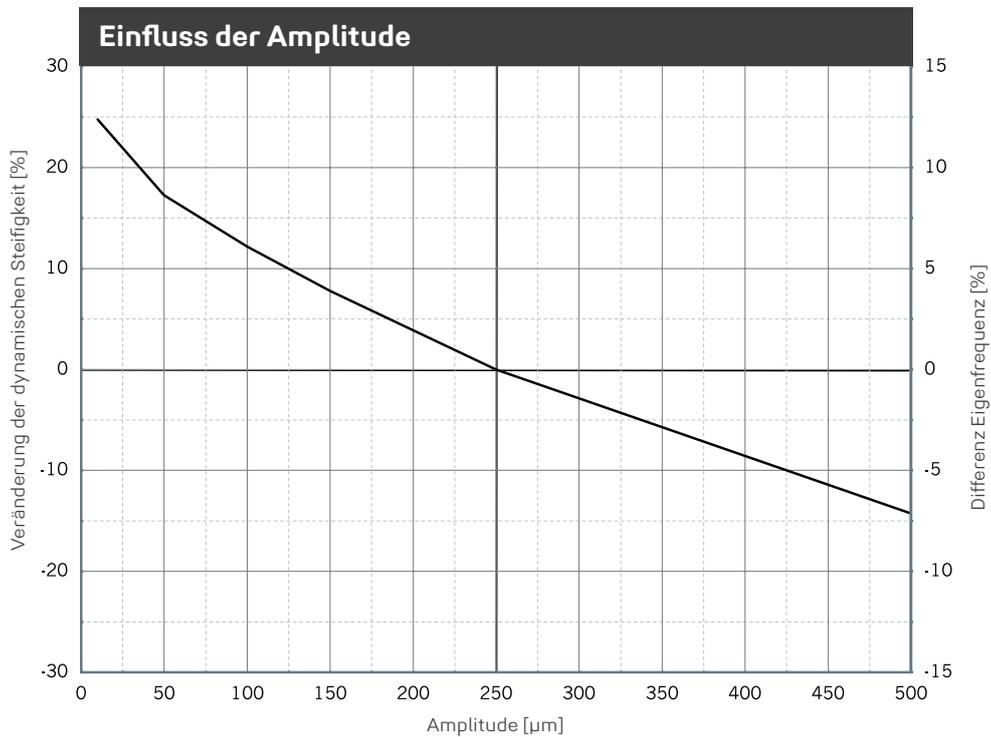
Veränderung der Steifigkeit aufgrund geänderter Amplitude. Mittelwert für 5 Hz, 10 Hz und 40 Hz Anregung. Sinusförmige Anregung bei konstanter Mittellast von 0,05 N/mm<sup>2</sup>, Probenabmessung 300 x 300 x 51 mm. Eigenfrequenz für einen eindimensionalen Feder-Masse-Schwinger auf starrem Untergrund.
