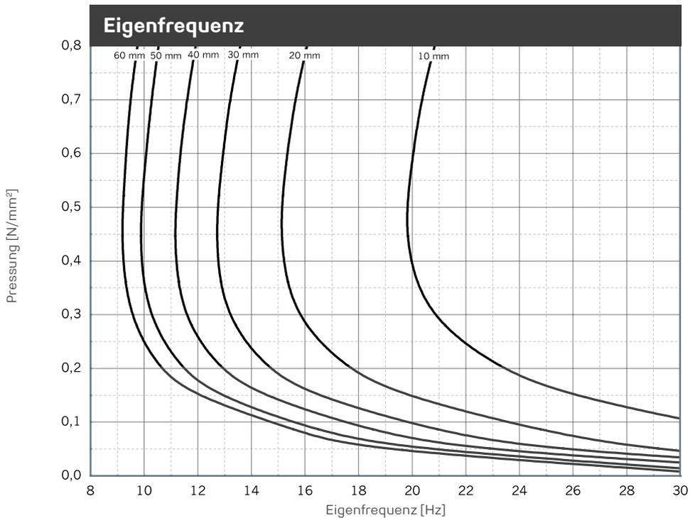
Eigenfrequenzverläufe für einen eindimensionalen Feder-Masse-Schwinger unter Berücksichtigung der dynamischen Steifigkeit von **REGUPOL vibration 800** auf starrem Untergrund. Probenabmessung 250 mm x 250 mm.
