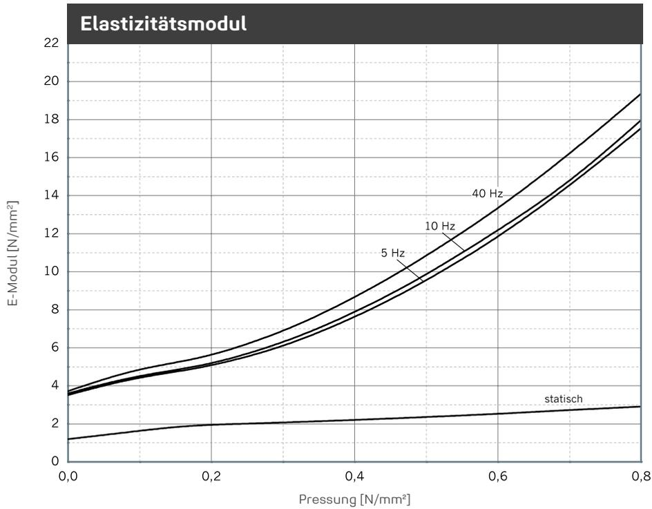
Verlauf des dynamischen E-Moduls bei sinusförmiger Anregung um eine konstante Mittellast, Wegamplitude  $\pm 0,25$  mm. Probenabmessung 250 mm x 250 mm x 40 mm; Statischer E-Modul als Tangentenmodul aus der Federkennlinie. Messung in Anlehnung an DIN 53513.
