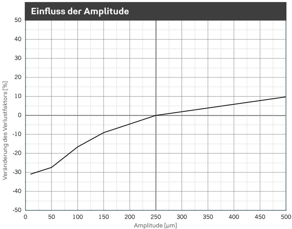
Veränderung des Verlustfaktors aufgrund geänderter Amplitude. Sinusförmige Anregung bei konstanter Mittellast von 0,80 N/mm<sup>2</sup>, Probenabmessung 250 x 250 x 60 mm.
