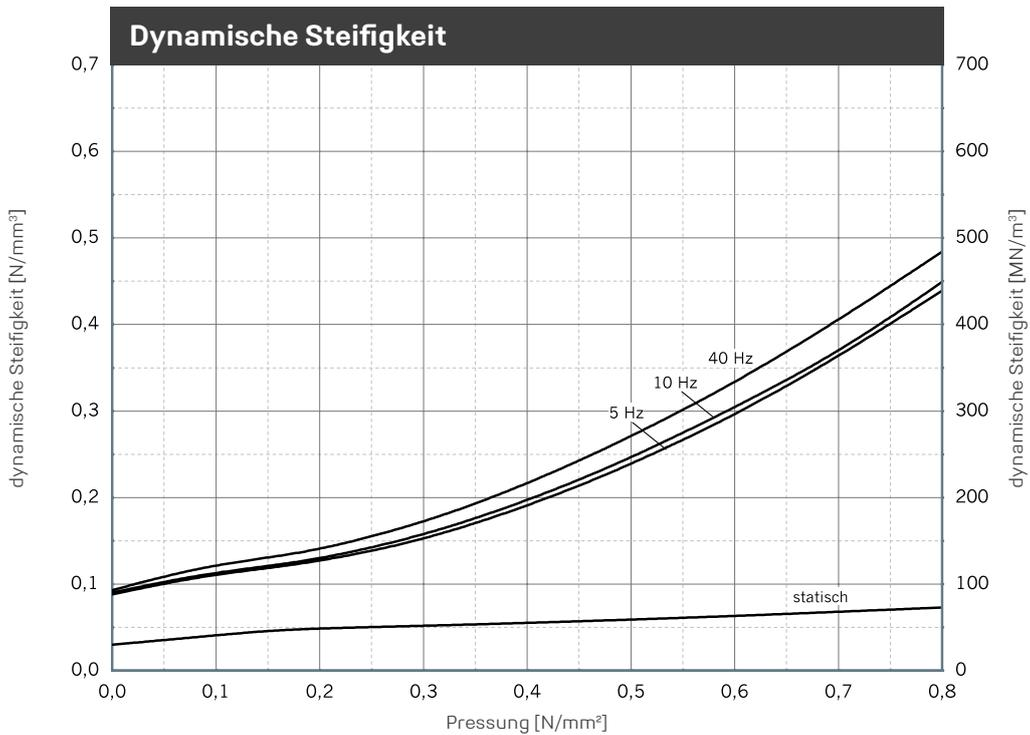
Verlauf der dynamischen Steifigkeit bei sinusförmiger Anregung um eine konstante Mittellast, Wegamplitude  $\pm 0,25$  mm. Probenabmessung 250 mm x 250 mm x 40 mm; Statische Steifigkeit als Tangentenmodul aus der Federkennlinie. Messung in Anlehnung an DIN 53513.
