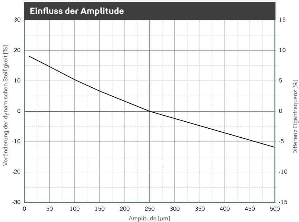
Veränderung der Steifigkeit aufgrund geänderter Amplitude. Mittelwert für 5 Hz, 10 Hz und 40 Hz Anregung. Sinusförmige Anregung bei konstanter Mittellast von 0,80 N/mm<sup>2</sup>, Probenabmessung 250 x 250 x 60 mm. Eigenfrequenz für einen eindimensionalen Feder-Masse-Schwinger auf starrem Untergrund.
