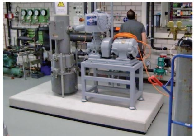
Vollflächige Maschinenfundamentlagerung mit **Regupol**®
