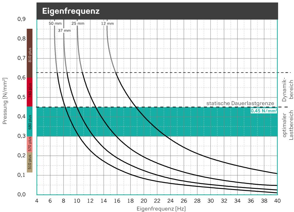
Eigenfrequenzverläufe für einen eindimensionalen Feder-Masse-Schwinger unter Berücksichtigung der dynamischen Steifigkeit von **REGUFOAM vibration 680plus** auf starrem Untergrund. Probenabmessung 300 mm x 300 mm.
