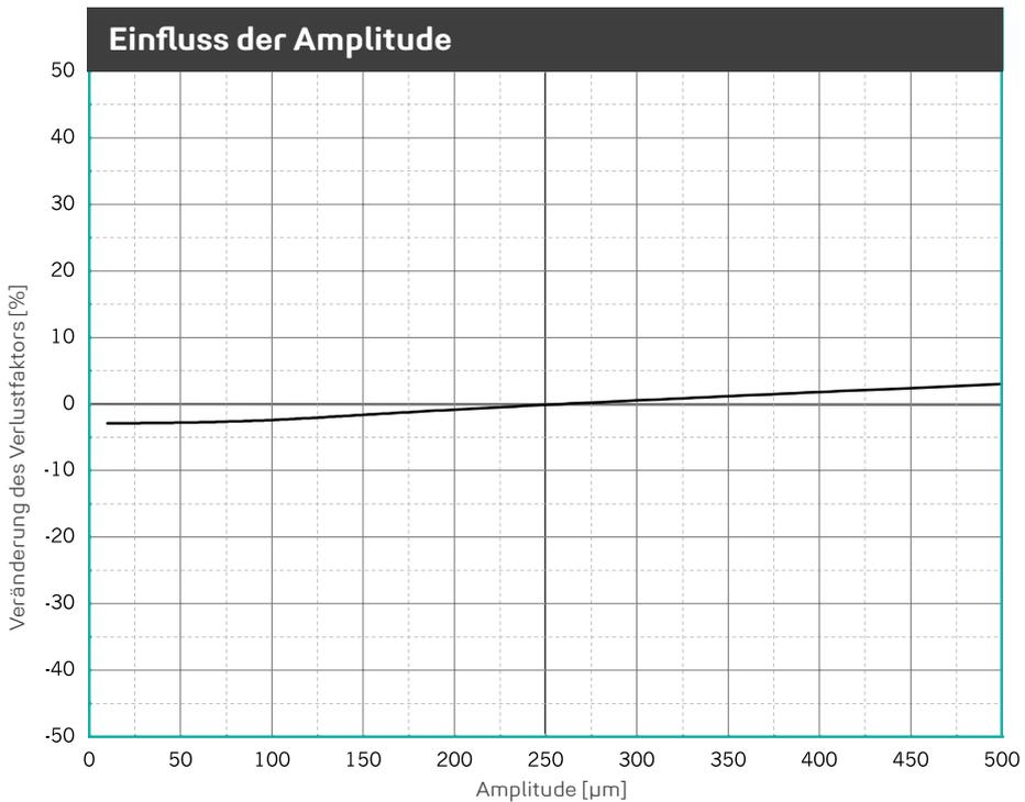
Veränderung des Verlustfaktors aufgrund geänderter Amplitude. Sinusförmige Anregung bei konstanter Mittellast von 0,450 N/mm<sup>2</sup>, Probenabmessung 300 x 300 x 25 mm.
