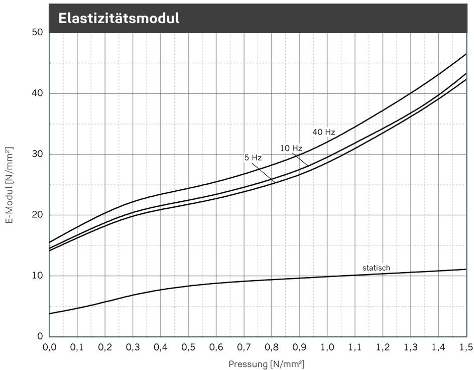
Verlauf des dynamischen E-Moduls bei sinusförmiger Anregung um eine konstante Mittellast, Wegamplitude  $\pm 0,25$  mm. Probenabmessung 200 mm x 200 mm x 40 mm; Statischer E-Modul als Tangentenmodul aus der Federkennlinie. Messung in Anlehnung an DIN 53513.
