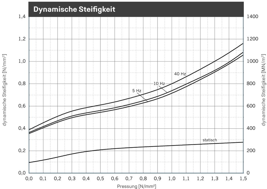
Verlauf der dynamischen Steifigkeit bei sinusförmiger Anregung um eine konstante Mittellast, Wegamplitude  $\pm 0,25$  mm. Probenabmessung 200 mm x 200 mm x 40 mm; Statische Steifigkeit als Tangentenmodul aus der Federkennlinie. Messung in Anlehnung an DIN 53513.
