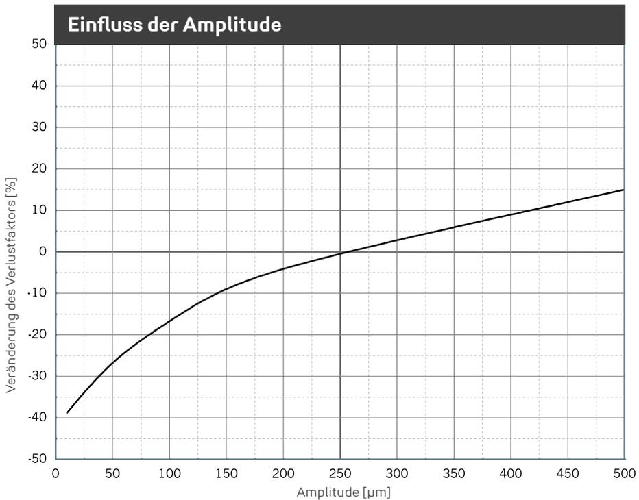
Veränderung des Verlustfaktors aufgrund geänderter Amplitude. Sinusförmige Anregung bei konstanter Mittellast von 1,50 N/mm<sup>2</sup>, Probenabmessung 200 x 200 x 60 mm.
