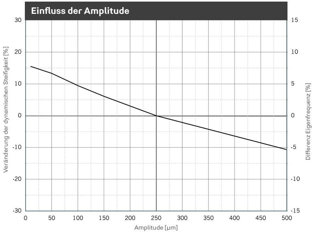
Veränderung der Steifigkeit aufgrund geänderter Amplitude. Mittelwert für 5 Hz, 10 Hz und 40 Hz Anregung. Sinusförmige Anregung bei konstanter Mittellast von 1,50 N/mm<sup>2</sup>, Probenabmessung 200 x 200 x 60 mm. Eigenfrequenz für einen eindimensionalen Feder-Masse-Schwinger auf starrem Untergrund.
