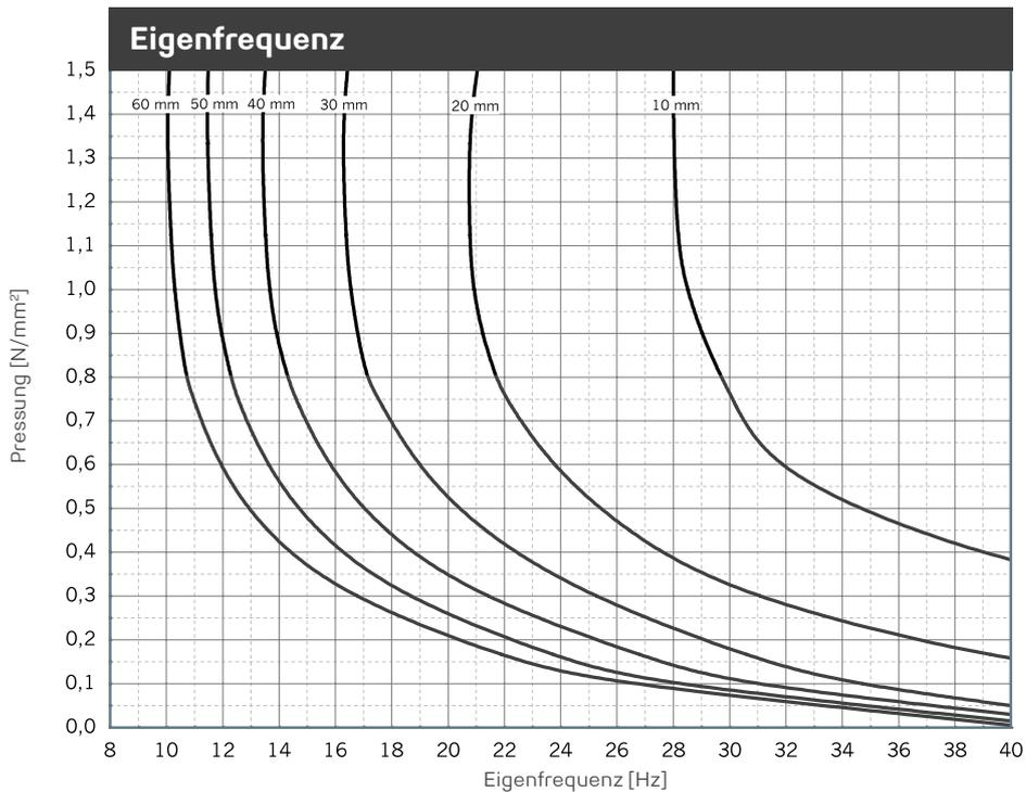
Eigenfrequenzverläufe für einen eindimensionalen Feder-Masse-Schwinger unter Berücksichtigung der dynamischen Steifigkeit von **REGUPOL vibration 1000** auf starrem Untergrund. Probenabmessung 200 mm x 200 mm.
