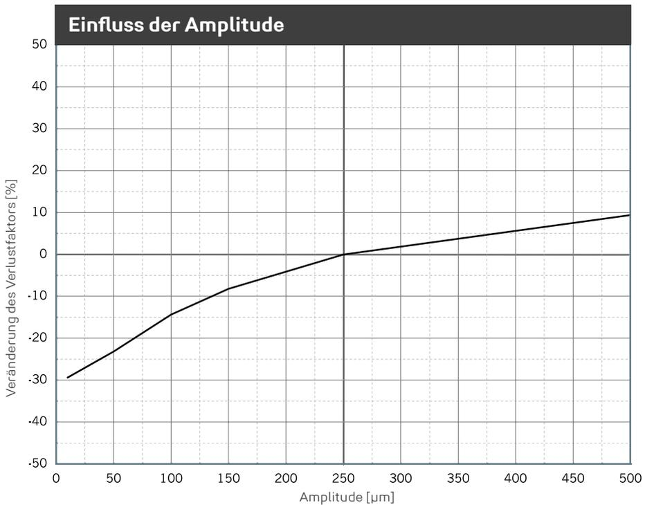
Veränderung des Verlustfaktors aufgrund geänderter Amplitude. Sinusförmige Anregung bei konstanter Mittellast von 0,10 N/mm<sup>2</sup>, Probenabmessung 300 x 300 x 50 mm.
