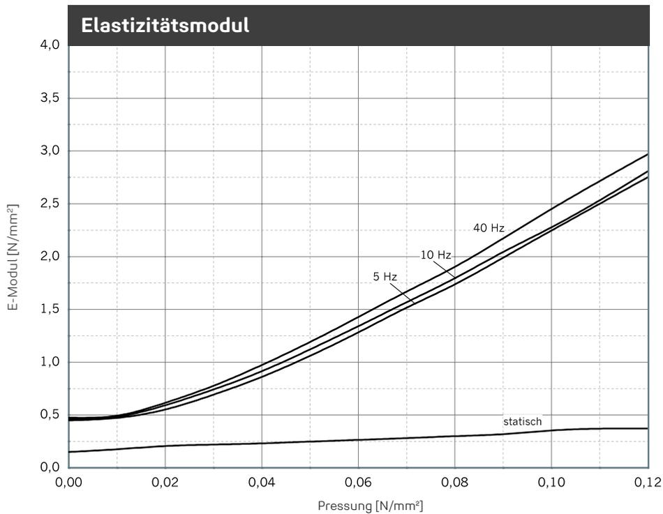
Verlauf des dynamischen E-Moduls bei sinusförmiger Anregung um eine konstante Mittellast, Wegamplitude  $\pm 0,25$  mm. Probenabmessung 300 mm x 300 mm x 50 mm; Statischer E-Modul als Tangentenmodul aus der Federkennlinie. Messung in Anlehnung an DIN 53513.
