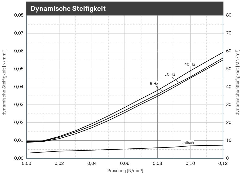
Verlauf der dynamischen Steifigkeit bei sinusförmiger Anregung um eine konstante Mittellast, Wegamplitude  $\pm 0,25$  mm. Probenabmessung 300 mm x 300 mm x 50 mm; Statische Steifigkeit als Tangentenmodul aus der Federkennlinie. Messung in Anlehnung an DIN 53513.
