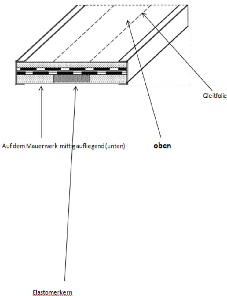
**Die sichere Funktion von Gleitlagerstreifen hängt unmittelbar von der fachgerechten Verlegung ab.**
