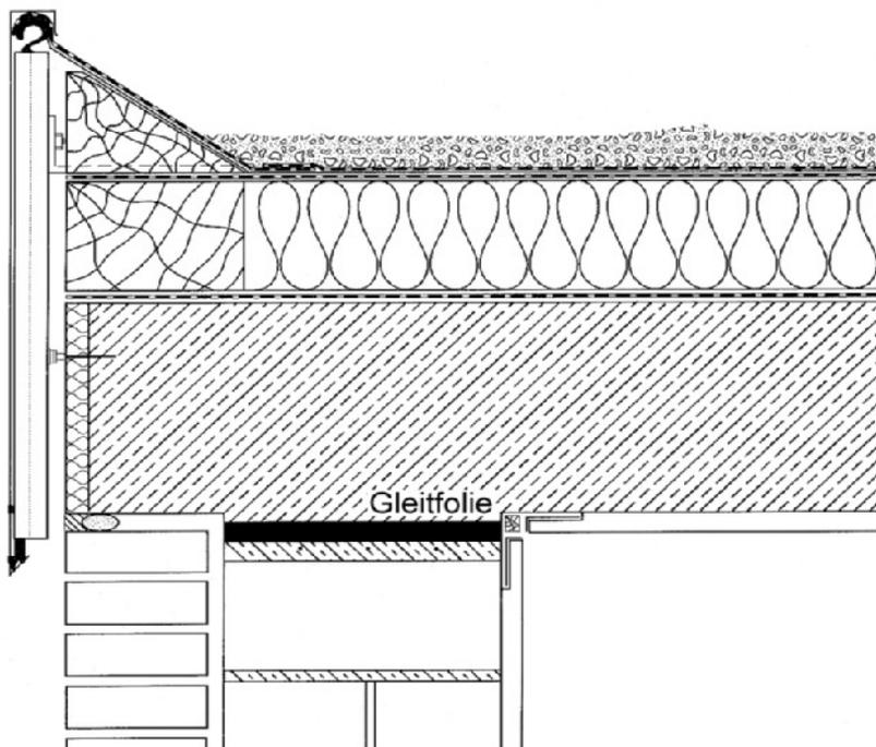
Die sichere Funktion von Gleitfolien hängt unmittelbar von der fachgerechten Verlegung ab.
