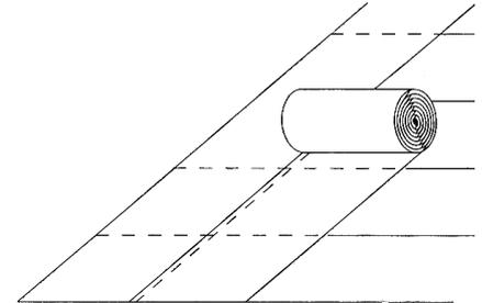
Im Gegensatz zu Gleitfolien, die ihre Verwendung zwischen Stahlbetondecken und den darunter liegenden Wänden finden, werden Großflächengleitlagerungen bei Eislaufbahnen, Schwimmbecken, Behältersohlen u.ä. vorgenommen.
