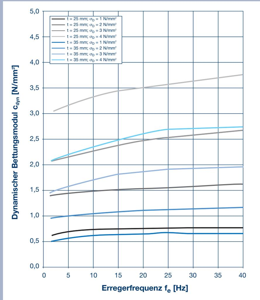
Bei einer Schwinggeschwindigkeitsamplitude von 1 mm/s
