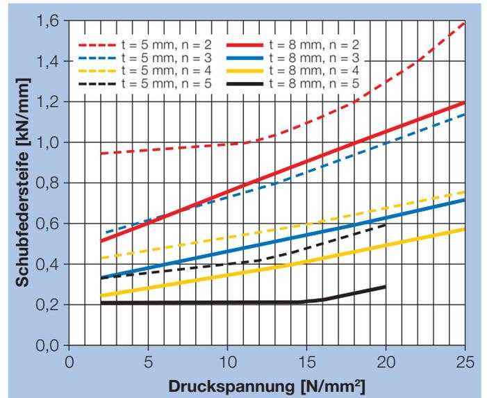
Bild 15: Flächenloch™-Lager 205-ST, Schubfedersteife; n = Anzahl der Elastomerschichten
