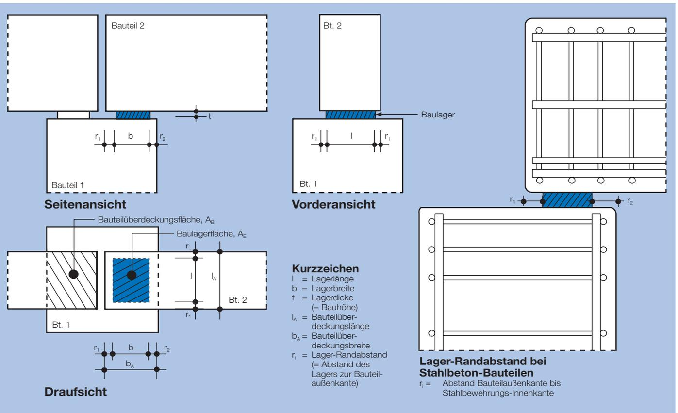
**Bild 5:** Maximale Größe der Grundrissfläche eines Elastomerlagers im Stahlbetonbau (Randabstand). Das Elastomer muss von der Bewehrung umschlossen werden. Bei Stahlbauteilen sollte der Randabstand des Elastomerlagers mindestens 4 cm betragen.
