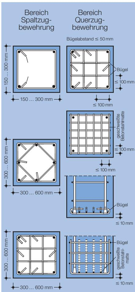
**Bild 7:** Empfohlene Querbewehrungsformen für Stützenenden nach Heft 339 DAfStb
