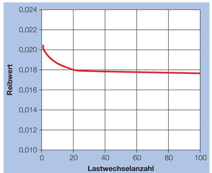
Bild 16: Flächenloch™-Gleitlager, Haftreibungswerte in Abhängigkeit von der Lastwechselzahl
