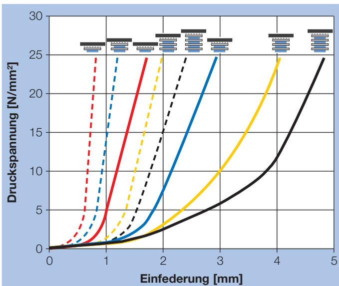
Bild 13: Flächenloch™-Gleitlager, Einfederung (näherungsweise)\*
