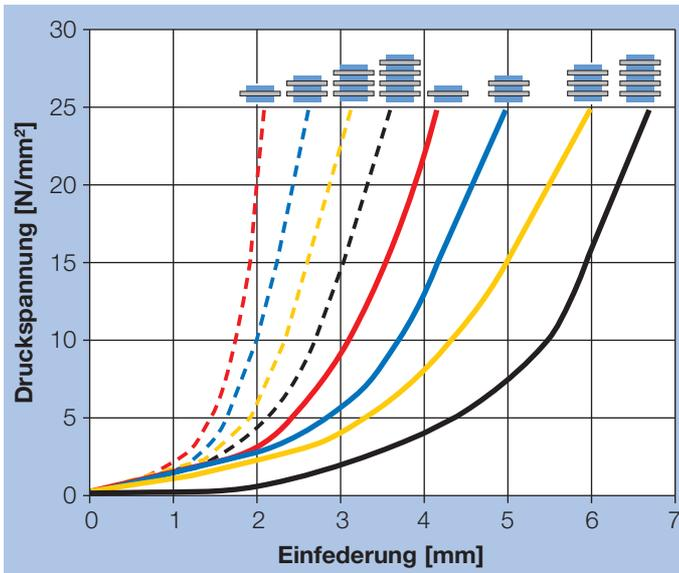
Bild 12: Flächenloch™-Lager 205-ST, Einfederung (näherungsweise)\*
