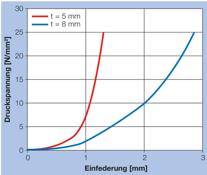
Bild 11: Flächenloch™-Lager 205, unbewehrt, Einfederung (näherungsweise)\*
